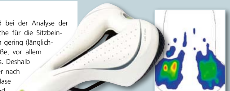
Das Druckmessbild des Herrensattels zeigt eine Druckablastung im Sattelheck. Die Kanten der Loch-aussparung üben gelegentlich Druck aus. Schwere Fahrer spüren die Kanten.
