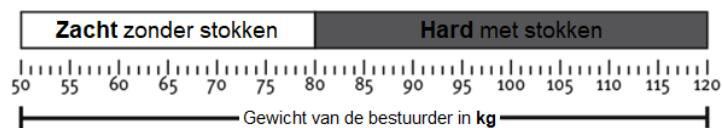
De configuratie van de stokken moet altijd symmetrisch zijn, d.w.z. links en rechts moeten altijd gelijkelijk zijn uitgerust. Zonder stokken wordt de demper zachter - vooral de rotatie rond de lengteas wordt sterker.
