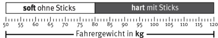
Die Konfiguration der Sticks sollte immer symmetrisch sein, das heißt Links und Rechts immer gleich bestückt. Ohne Sticks wird der Dämpfer weicher – insbesondere die Drehbewegung um die Längsachse wird stärker.
