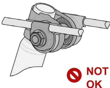
Vermijd ook het monteren van een SQlab 600 active zadel met behulp van een zogenaamde zadelpenstrop. Het klemoppervlak van dergelijke metalen constructies is over het algemeen te kort en te klein, waardoor een afdoende klemming, zonder dat daarbij het onderstel van het zadel beschadigd raakt, niet kan worden gewaarborgd.
