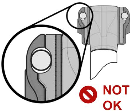
Montieren Sie Ihren SQlab 600 active Sattel keinesfalls in einer Sattelstütze, die für die Montage von anderen Streben durchmessern oder Strebenquerschnitten (wie z. B. 7 x 9 mm) vorgesehen ist.
