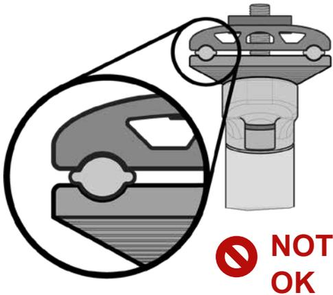
Houd je aan het in de gebruiksaanwijzing van je zadelpen voorgeschreven aandraaimoment van de zadelpenklemming. Overschrijd in geen geval het maximale aandraaimoment van 18 Nm. Raadpleeg je SQlab-dealer als in de gebruiksaanwijzing van je zadelpen een hoger aandraaimoment voorgeschreven wordt.
