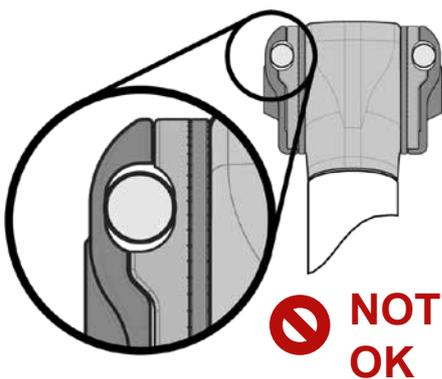
Ne montez jamais votre selle SQlab 600 active sur un support de selle prévu pour le montage d'autres diamètres de tiges ou de sections de tiges (comme par ex. 7 x 9 mm).
