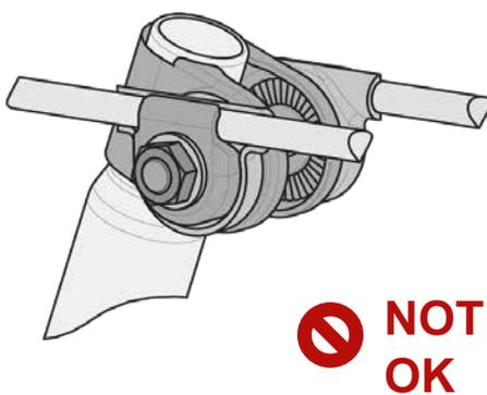
Il faut éviter dans tous les cas de serrer l'armature de la selle avec des mâchoires ou des surfaces de serrage qui ne sont correspondent pas.
