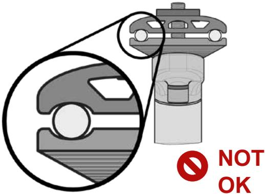
Montieren Sie Ihren SQLab 600 active Sattel keinesfalls in einer Sattelstütze, deren Klemmflächen nicht zu den Rundstreben mit einem Durchmesser 7 mm passen. Die Beeinträchtigung der Produktsicherheit und eine Schädigung mit Bruchfolge wären voraussehbar. In einem solchen Fall könnte das Sattelgestell während des Gebrauchs plötzlich und unvermittelt brechen und zu einem Unfall führen.
