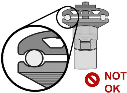
Monteer je SQlab 600 active zadel in geen geval in een zadelpen waarvan het klemmechanisme niet exact past op een onderstel met een buisdiameter van 7 mm.
